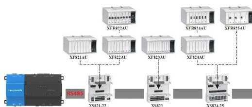
Panel-Bus-Module kommunizieren über die **RS-485**-Schnittstelle mit einer Baudrate von **115,2 kbps**. Die gesamte Adressierung erfolgt mit einem HEX schalten. Ausgangsmodule sind mit manuellen Überbrückungsschaltern / Potentiometern für die einfache Bedienung erhältlich. Panel-Bus-Module ermöglichen es, alle Arten von Anwendungen abzudecken.
